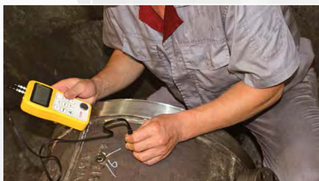
Измерение толщины стены
