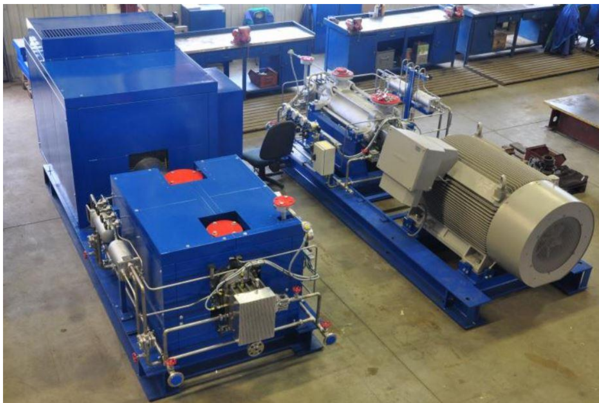
Питательный агрегат с шумозащитным кожухом насоса и двигателя Вода 180°C, Q=130м³/ч, H=1075м, Plan 23, ЭД560кВт, 3030об/мин.
